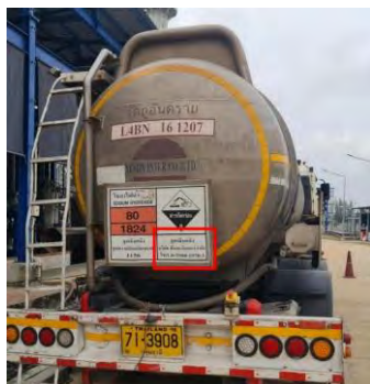
ภาพที่ 2-28 การติดเครื่องหมาย ป้ายวัตถุอันตราย และเบอร์โทรศัพท์ที่ตัวถังของรถบรรทุกสารเคมี
